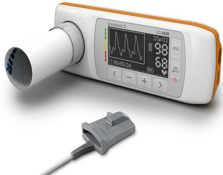
Spirometro portatile con ossimetro integrato e turbina usa e getta
